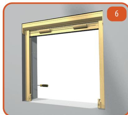
Fissare le guide verticali alle pareti con le viti.
